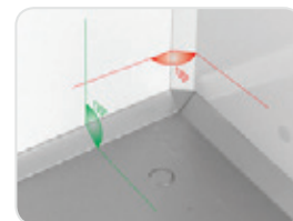
Wycięcie o kącie 135° dla łatwiejszego czyszczenia
